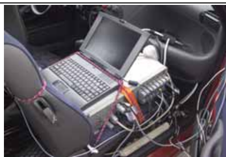
Ryc. 2. Aparatura rejestrująca zamontowana w samochodzie.
